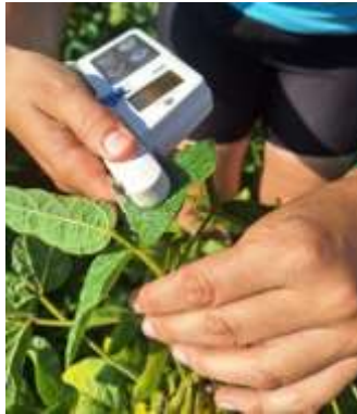
11. ábra: A kísérlet során használt SPAD eszköz (Forrás: Saját kép, 2023)
