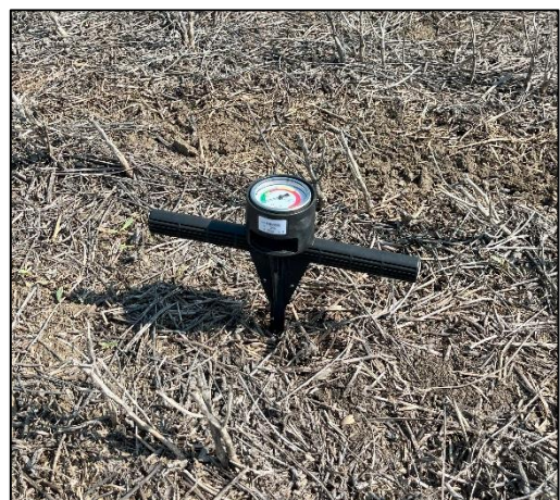
3. ábra: Penetrométerezés (Forrás: saját kép, Kiszombor, 2023. 05. 05.)
