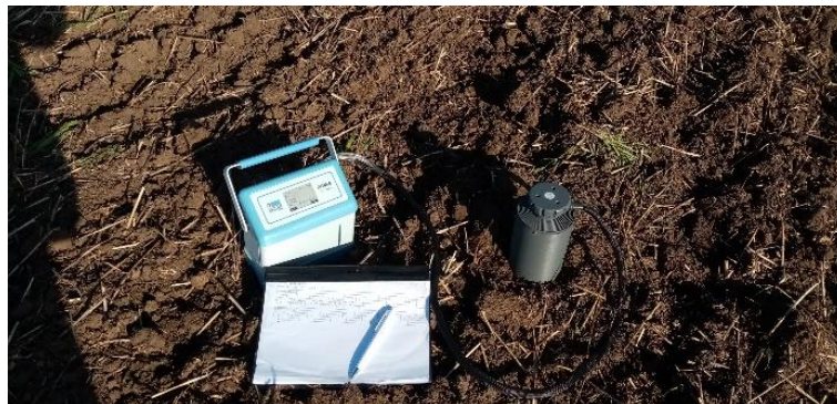
3. kép A szén-dioxid kibocsátás mérése infravörös- gázanalizátorral (Forrás: Saját fotó)
