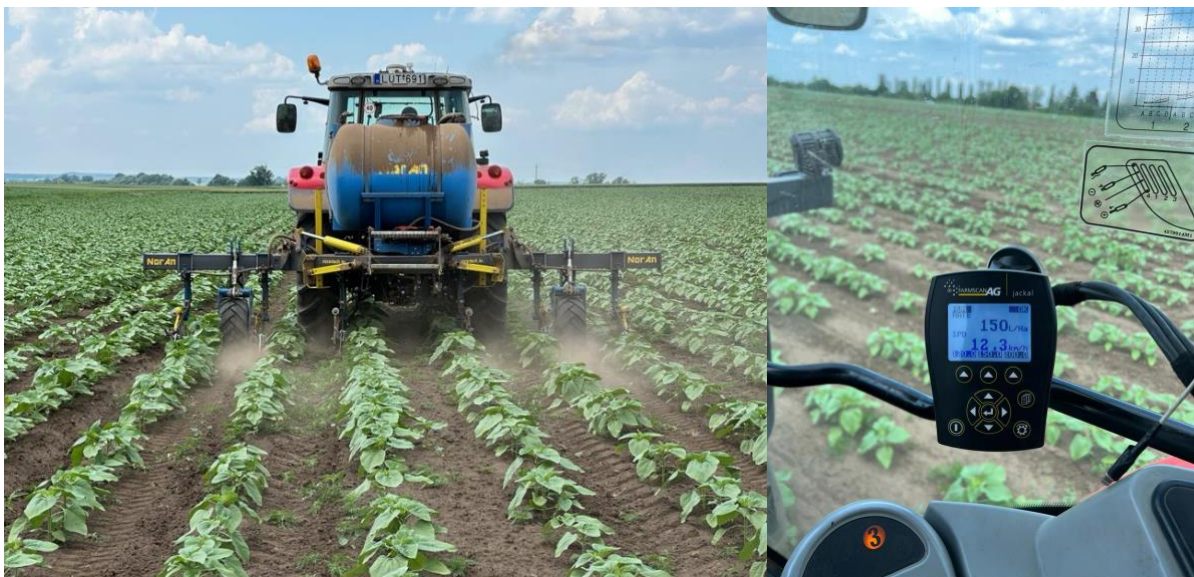
10. ábra: Nitrosol és Limus ureáz inhibitor injektálása (Forrás: saját kép, Dány, 2023. június 2.)
