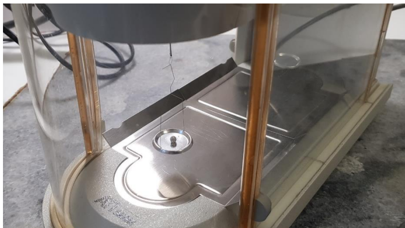
4. ábra: ónkapszulába csomagolt minta súlymérése mikromérleggel (forrás: saját fotó)
