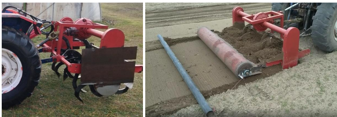
1.8. ábra Ásógéppel történő magágykészítés forrás: (saját felvétel)
