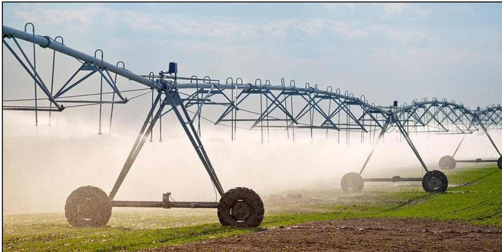
3. ábra: Frontálisan mozgó öntözőberendezés (linár) (Forrás: Google)
