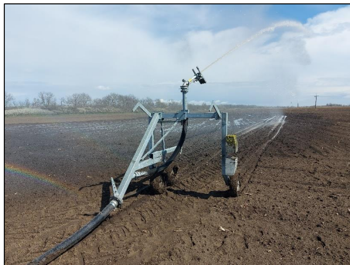
7. ábra: A vizsgálathoz használt vízagyú (Forrás: saját kép)
