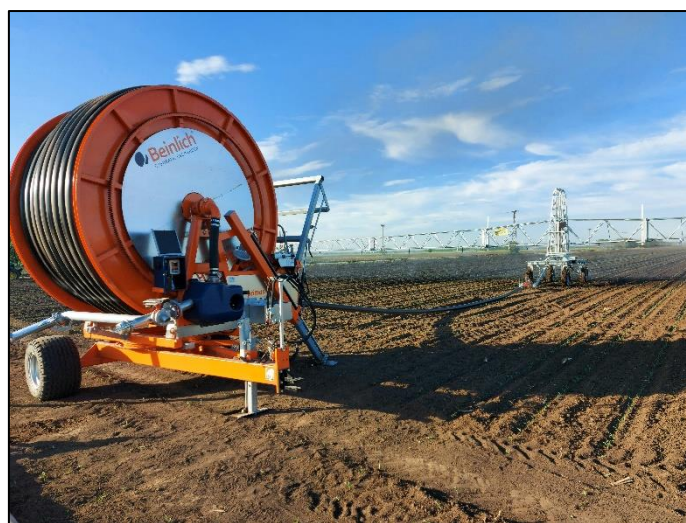
2. ábra: Öntöződob konzollal (Forrás: saját kép)
