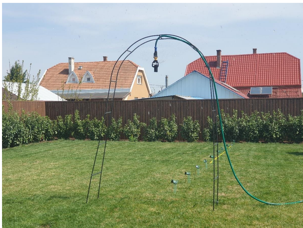
24.ábra Komet KPT szórófej elhelyezkedése a méréshez
