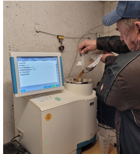
16. ÁBRA: MÉRÉS NIR-ELEMZŐVEL (FORRÁS: SAJÁT FELVÉTEL)
