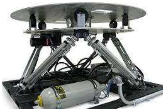
7. ábra: Hidraulikus aktuátorral felszerelt szimulátor (Forrás: Hydraulic Controls)
