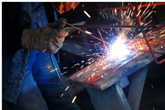
39. ábra: Bevonat elektródás kézi ívhegesztés (Forrás: The Precision Companies)
