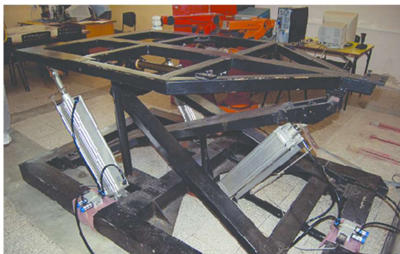
6. ábra: Pneumatikus aktuátorral felszerelt szimulátor (Forrás: ResearchGate)
