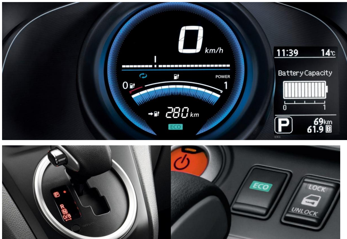
23. ábra: Nissan E-NV200 műszerfal és B/ECO mód lehetőségek.
