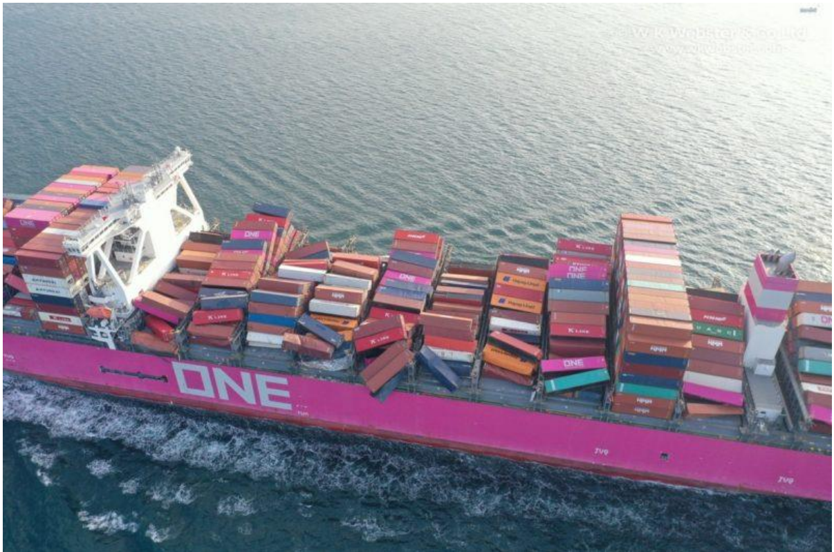
13. ábra ONE APUS fedélzetén konténerköteg összeomlása
