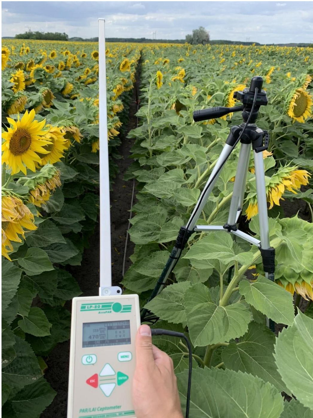
9. ábra: Napraforgó levélfelületi indexének mérése 2022-es szezonban
