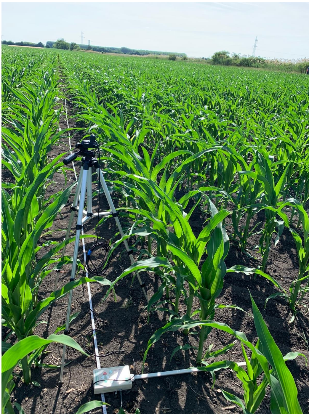
10. ábra: Kukorica levélfelületi indexének mérése 2022-es szezonban
