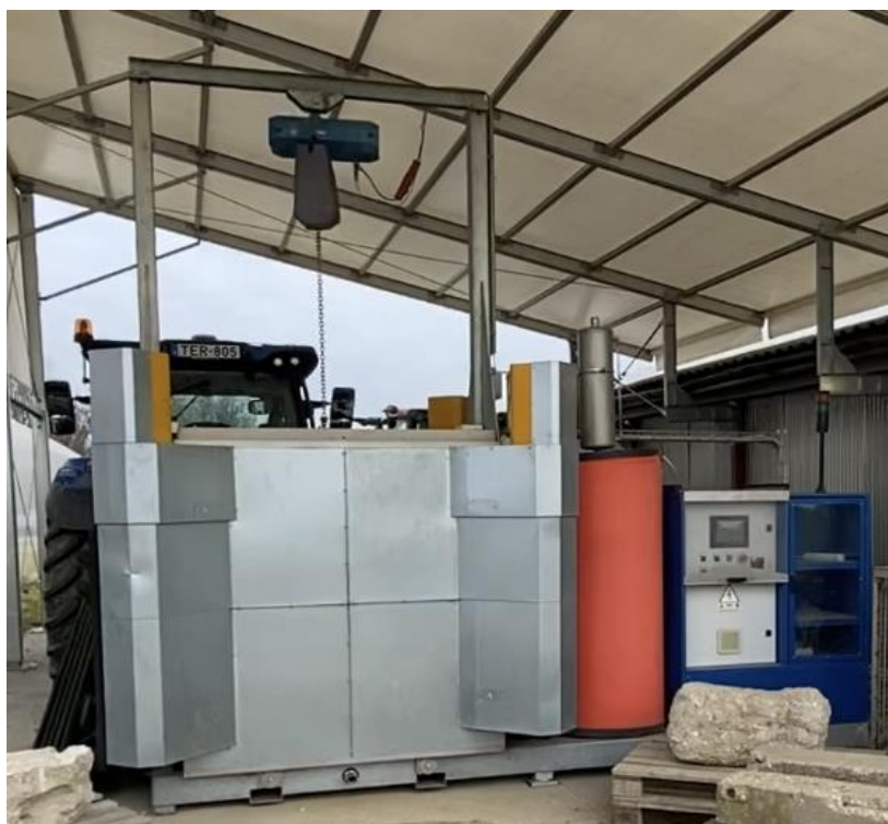
7. ábra Termoterápiás fertőtlenítőgép (Saját)
