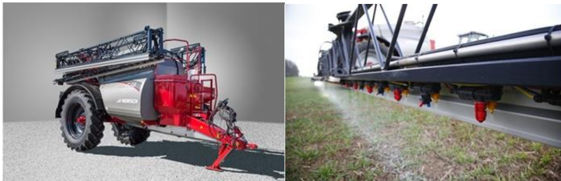
6. ábra Horsh Leep vontatott szántóföldi permetező keretmagasság és fúvókátávolság (INTERNET5)
