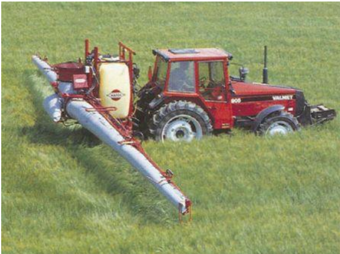
5. ábra Légfüggönyös permetezőgép (INTERNET4)
