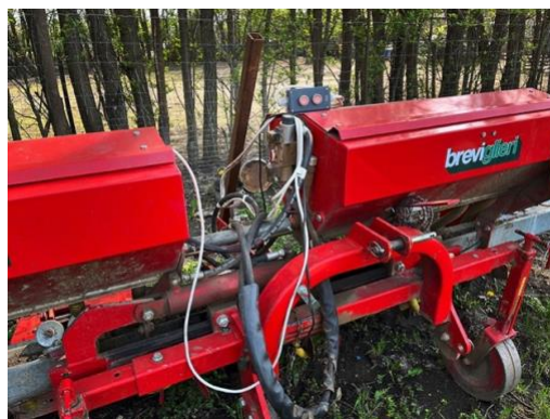
5. ábra: Távvezérelt sorközművelő talajmaró, Forrás: Saját felvétel
