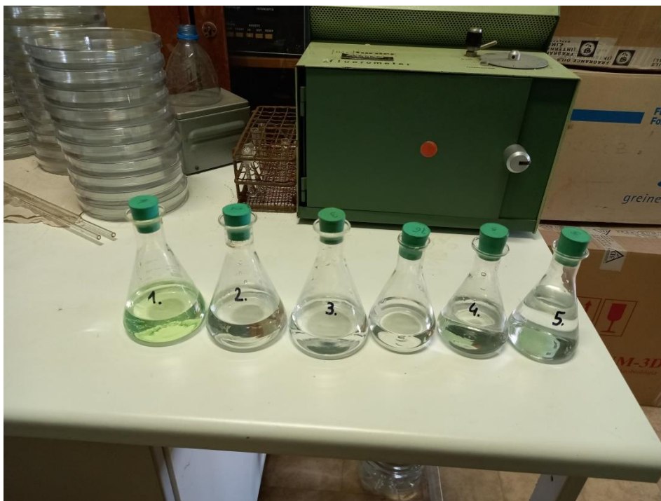
10. ábra: Standard hígítási sor (Saját készítésű fénykép)
