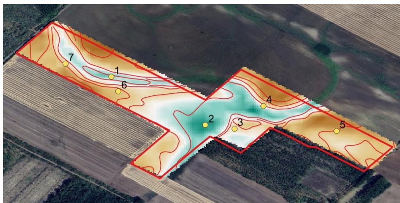
22. ábra Magassági térkép a Lechner Tudásbázis adatbázisából vásárolt adatok alapján a mintavételi pontokkal
