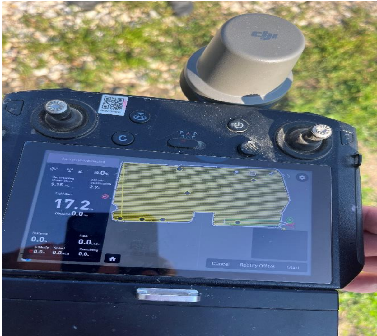
18. ábra Képen látható a drón irányítója, egy RTK antennával.2023, Bozó Á. Forrás: Saját kép
