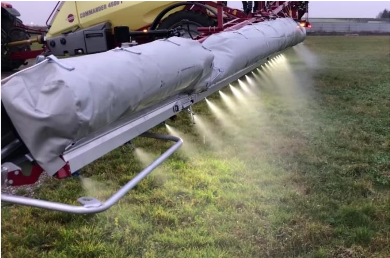
4. ábra Légzsákos permetezőgép működés közben. 2021, Hardi, Forrás: http8
