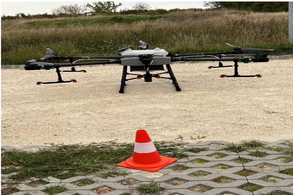
2. ábra DJI-T30 akkumulátorral felszerelt permetező drón. 2022: Fotó: Bozó Ákos, saját kép
