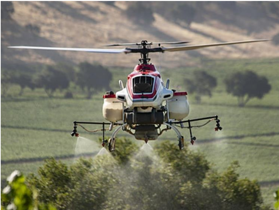
1. ábra A Yamaha Rmax munka közben belsőégésű motorral és helikopter formával. 2016, Fotó: Yamaha (forrás: http2 )
