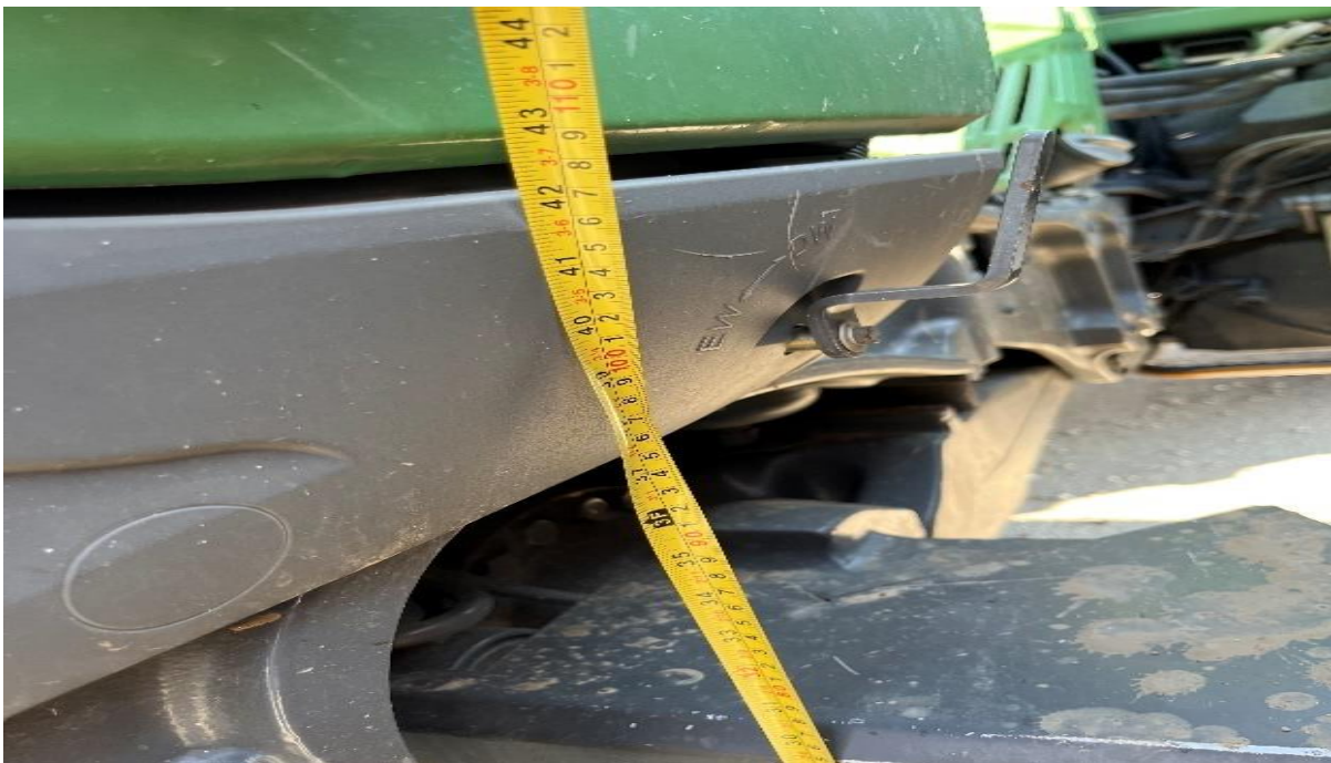
22. ábra A képen látható a gép hasmagassága 2023, Bozó Ákos Forrás: Saját kép
