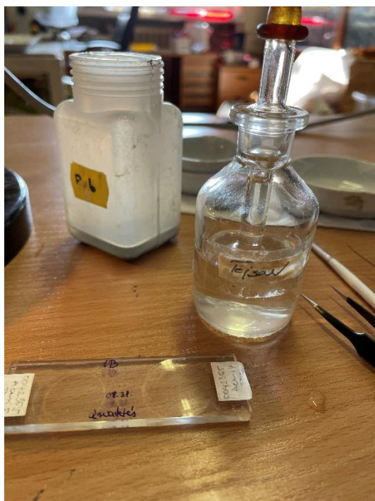
8. ábra: A preparáláshoz alkalmazott eszközök: mélyített tárgylemez, tejsav, csipesz, ecset, tű (Fotó: Lukács Dorottya, Budapest 2023)
