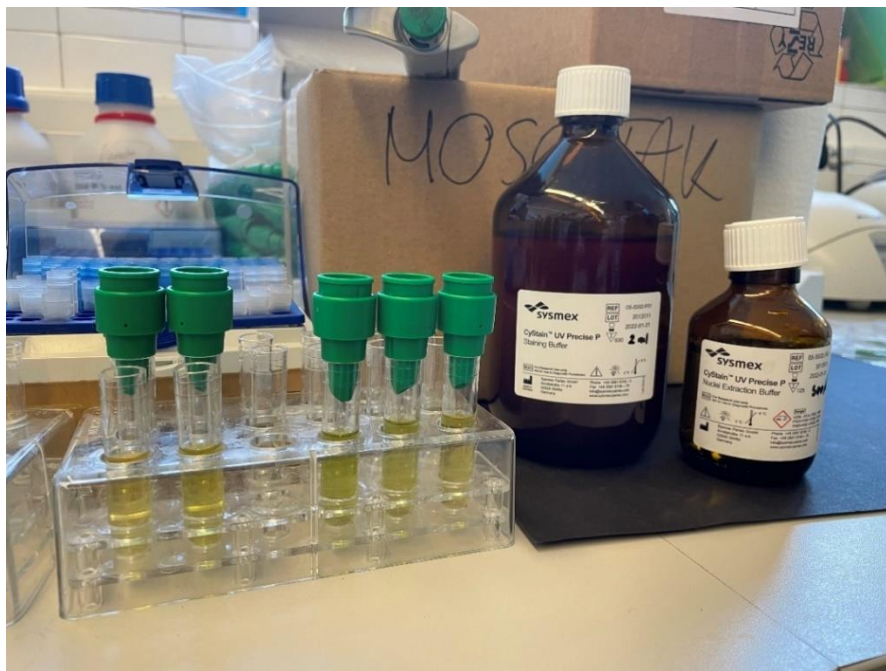
9. ábra: A flow citométerhez használt sejtfeltáró- és színező puffer oldatok (CyStain UV Precise P), valamint a szűrőn keresztül a küvettába juttatott növényi minták (saját kép).
