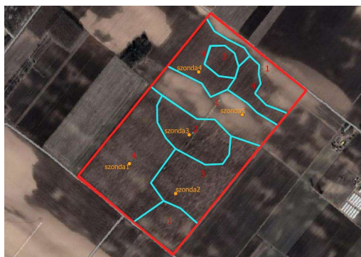
33. ábra Talajszonda elhelyezés tervezet (QGIS, saját)
