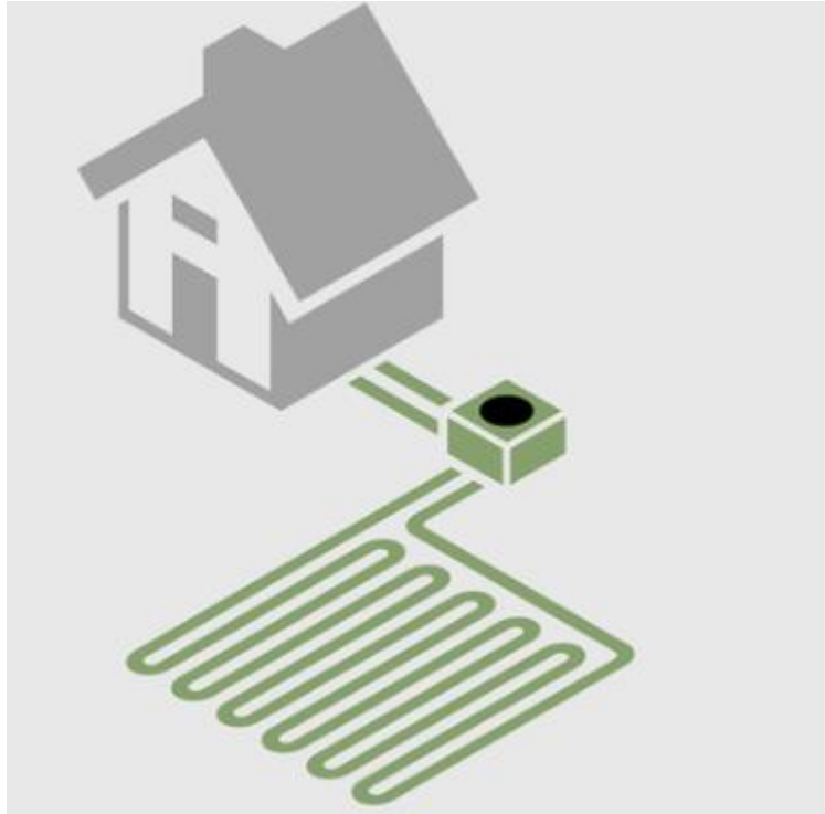
10. ábra: Talajkollektoros hőszivattyú talajcsövezés (forrás: Rehau)
