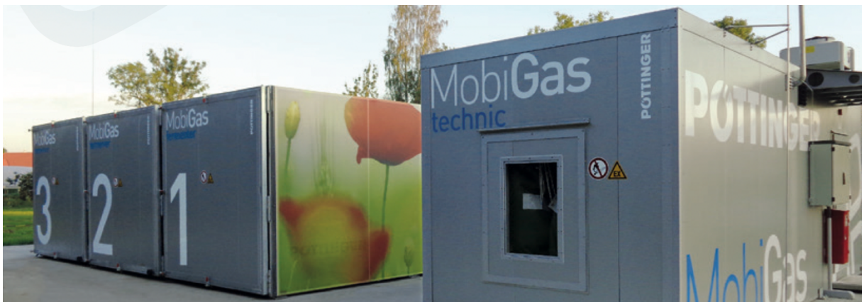
3. ábra: A Pöttinger MobiGas száraz fermentációs biogázrőmő fotója Forrás: Pöttinger Entsorgungstechnik
