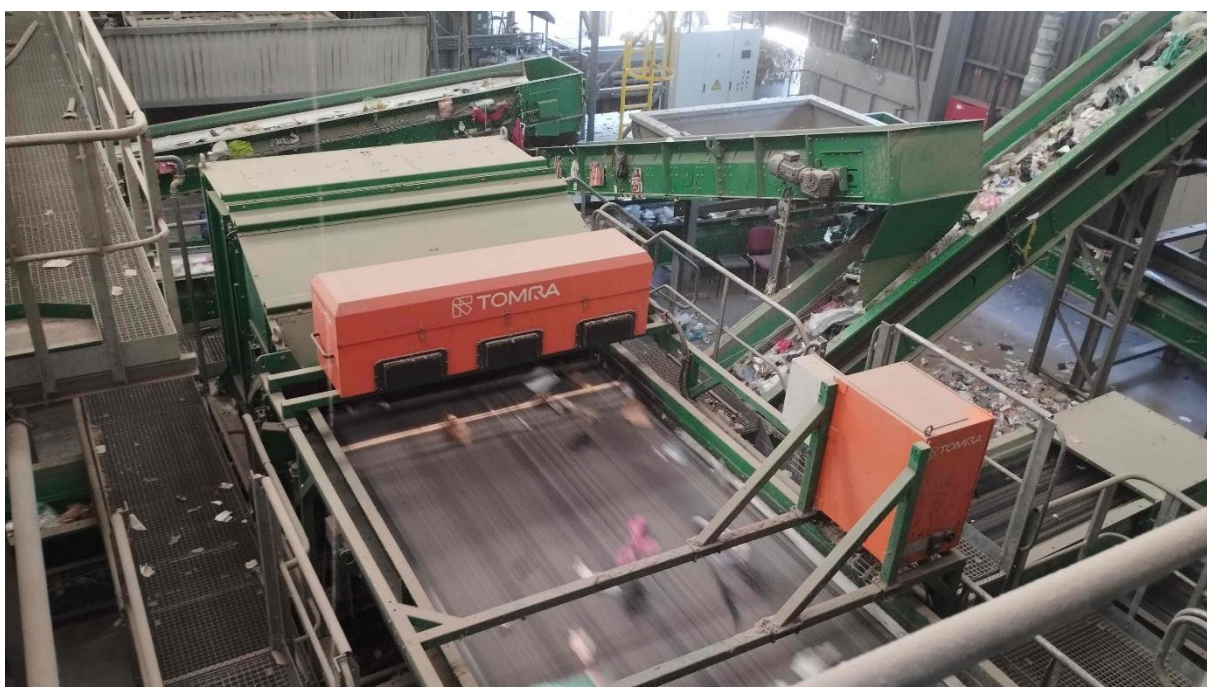
1/c: Válogató üzem - Infrafelismerő rendszer (NIR) segítségével történő válogatás
