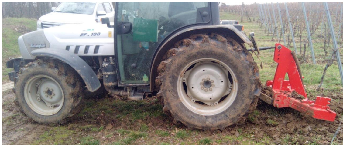
8. ábra Jympa talajlazító munka közben
