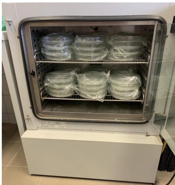
6. ábra Binder típusú hűtő fűtő termosztát a behelyezett Petri csészékkel Saját készítésű képek
