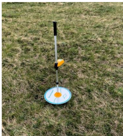
13. ábra. A Grasshopper G2 RPM tárcsás hozambecslő eszköz (fotó: Kovács Dániel, 2022)
