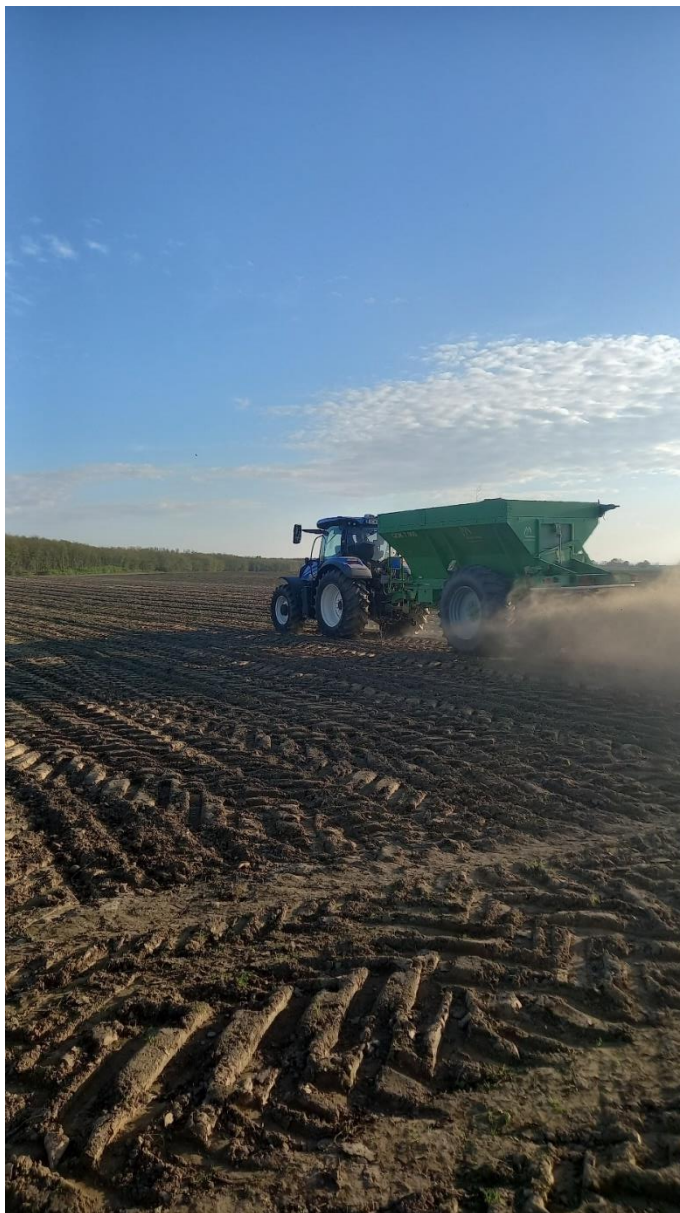
3. ábra New Holland T6.180 AC&Güstrower GDK7.000-es műtrágyaszóró mésziszap szórás közben
