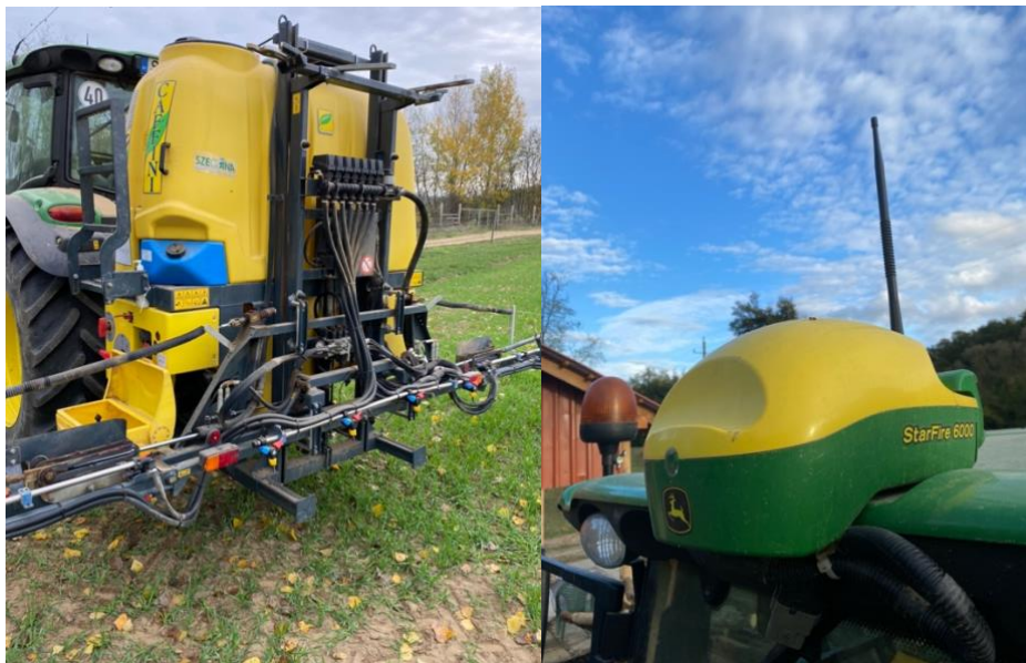
8.ábra: Bal oldalt a permetező, jobb oldalt pedig az rtk antenna látható (Forrás: Saját fotó).
