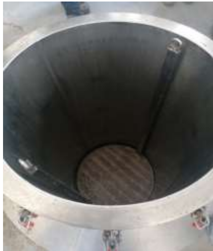
4.ábra: Lepárló üst Forrás: saját felvétel, 2021.10.15
