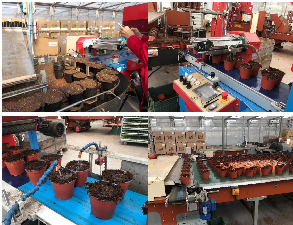
5-8. ábra: A vetőhenger és a vetési folyamat a Zöldpont Fűszerkertészetben (forrás: saját kamerával készített felvétel)
