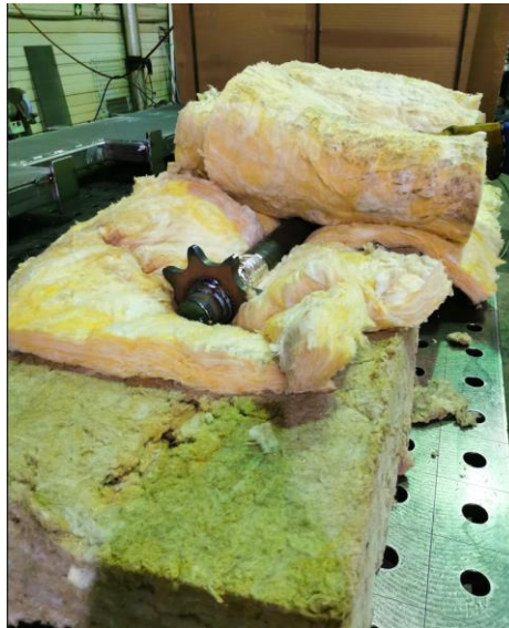
4.3. ábra: Hegesztés után Therwollin ágyban elhelyezett munkadarab
