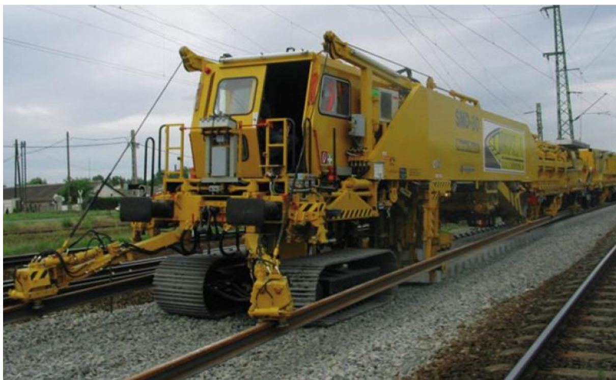
2.3. ábra SMD 80 géplánc munka közben {3}
