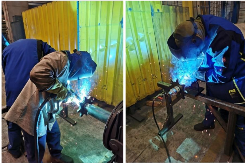
4.2. ábra: Hegesztő szakemberek egyidejű munkája a meghajtó tengely tompavarratának hegesztése közben
