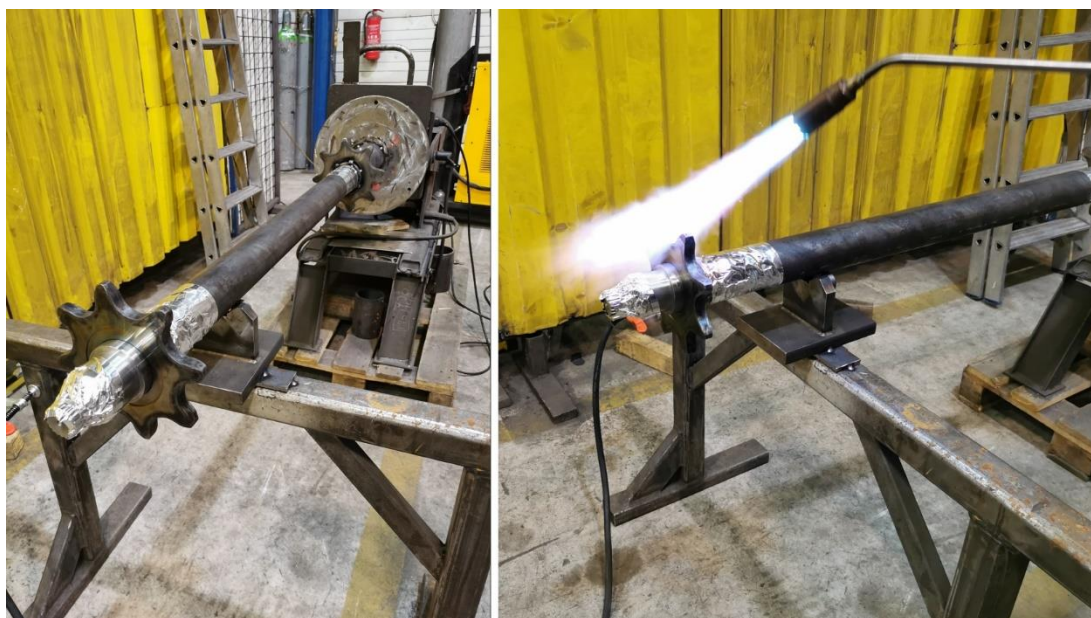
4.1. ábra: A munkadarab összeállított állapotban a forgatóban és az előmelegítés kezdeti pillanata kép jobb oldalán
