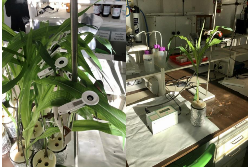
11. ábra: Felhelyezett klipszek (baloldal), és a fluoreszcencia mérése (jobb oldal) FMS-2 fluorométerrel (Fotó: Mónos Gréta, 2022)
