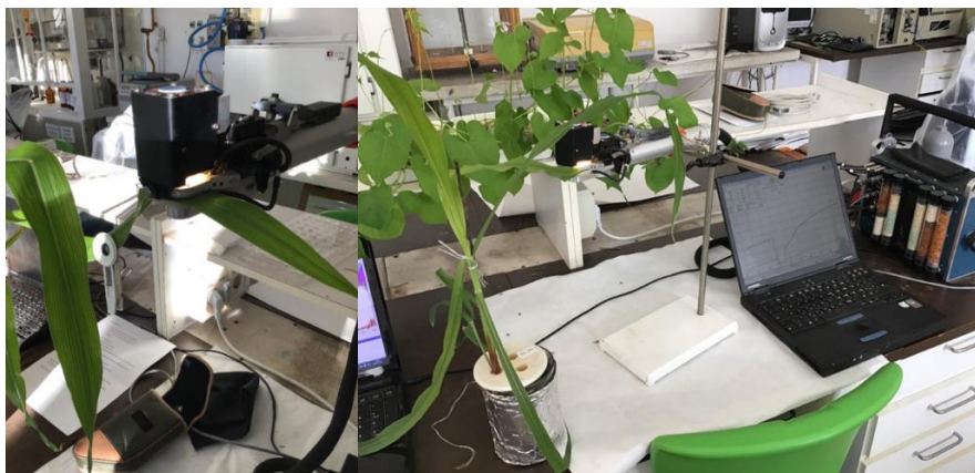
10. ábra: A CIRAS-2 gázanalizátor lámpája (baloldal) és a fotoszintézis mérése (jobb oldal) (Fotó: Mónos Gréta, 2022)
