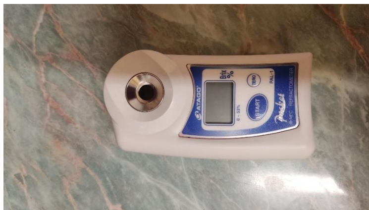
3.ÁBRA A BRIX (ATAGO) MÉRŐ MŰSZER
