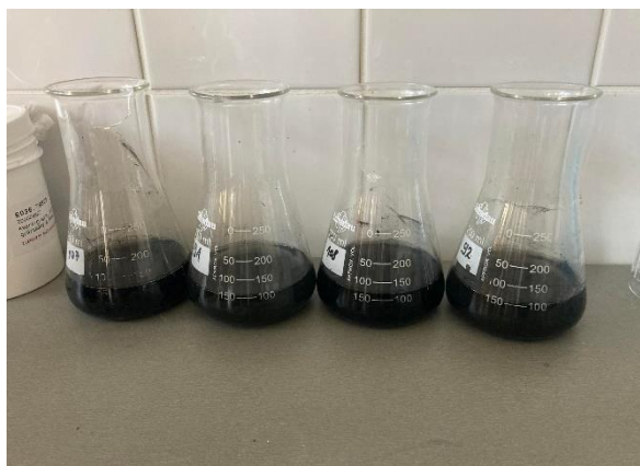
4. ábra Olsen féle foszfor meghatározás Forrás: saját kép (2023)
