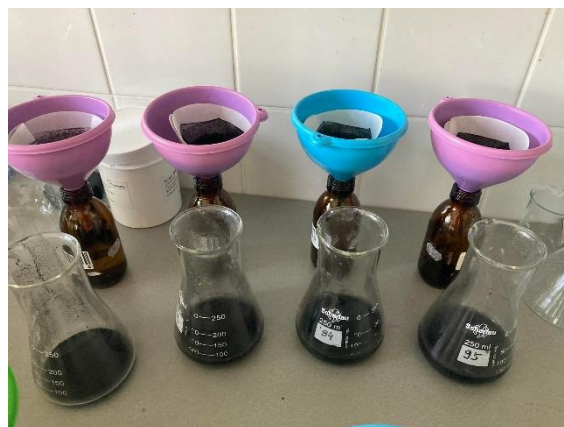
5. ábra Olsen féle foszfor meghatározás Forrás: saját kép (2023)
