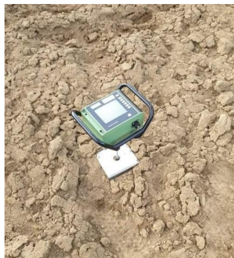
3. ábra Penetrologger Forrás: saját kép (2022)
