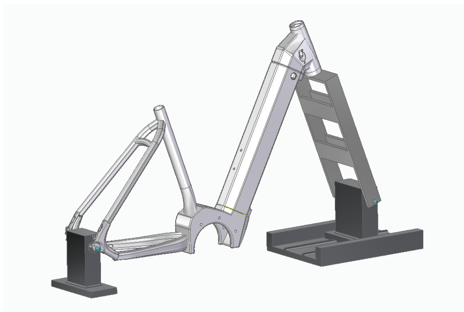
32. ábra: A negyedik szimuláció Solid Edge modellje
