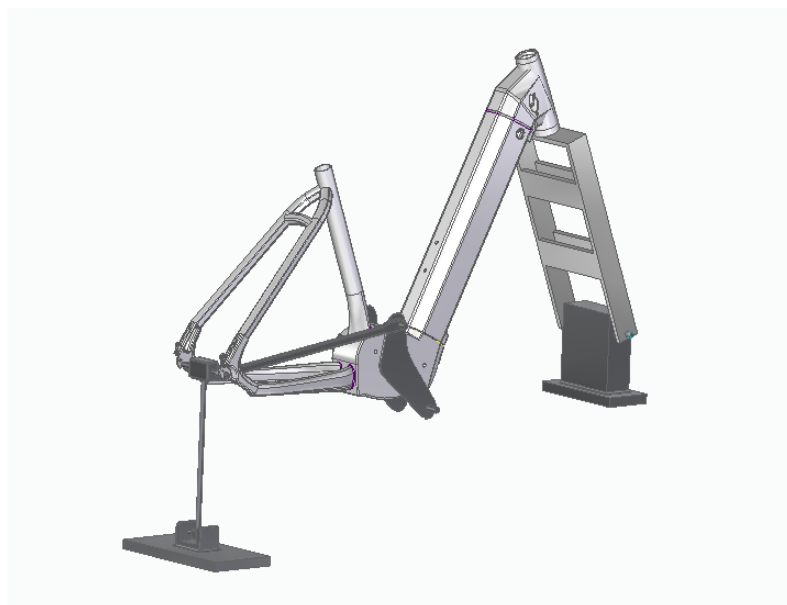
27. ábra: A harmadik szimuláció Solid Edge modellje
