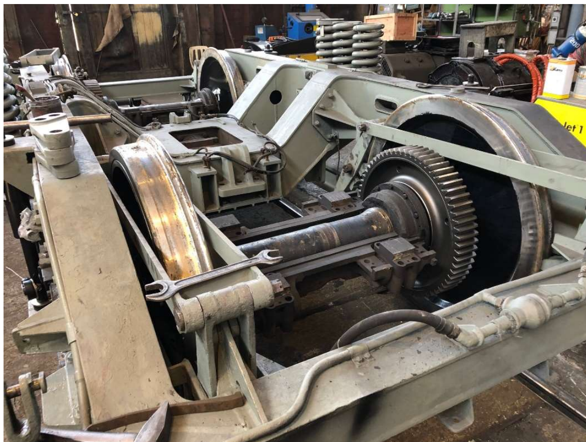
18. ábra: A 450 003 mozdony felújított forgóváza az új fogaskerékkel (forrás: saját készítésű felvétel)
