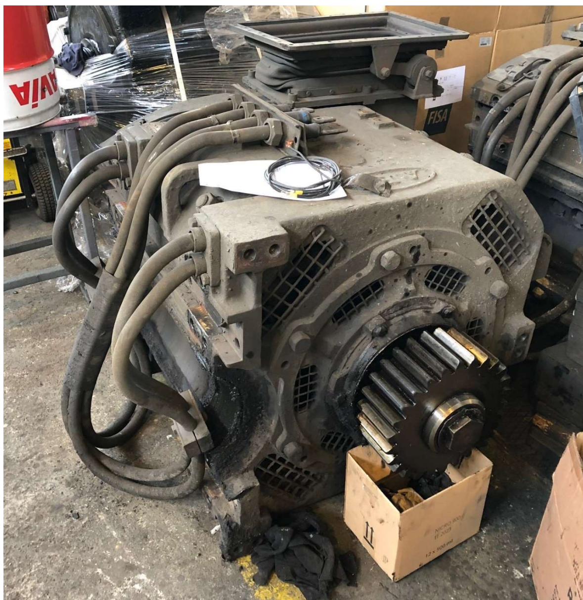
19. ábra: 450H sorozatú villamosmozdony BZ 282 AEI típusú vontatómotorja
