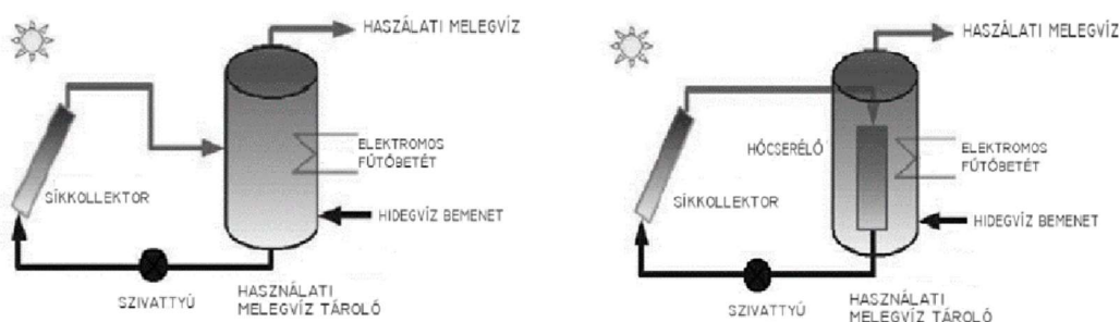
14. ábra: a) egykörös szolár rendszer; b) kétkörös szolár rendszer (Patel, et al., 2012)
