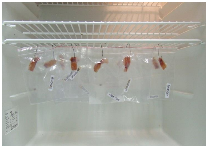
3. ábra: Csepegési veszteség mérése ponty filében
