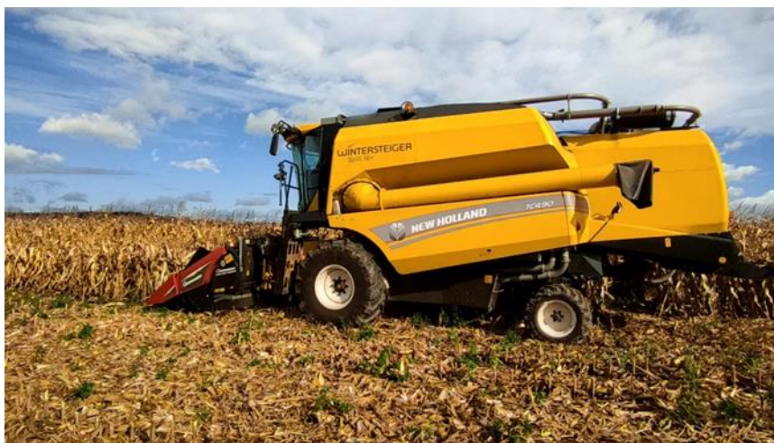
9. ábra: Wintersteiger Split NH: New Holland TC4.90 betakarítógép, ami a Wintersetiger által parcellakombájnná lett átalakítva
