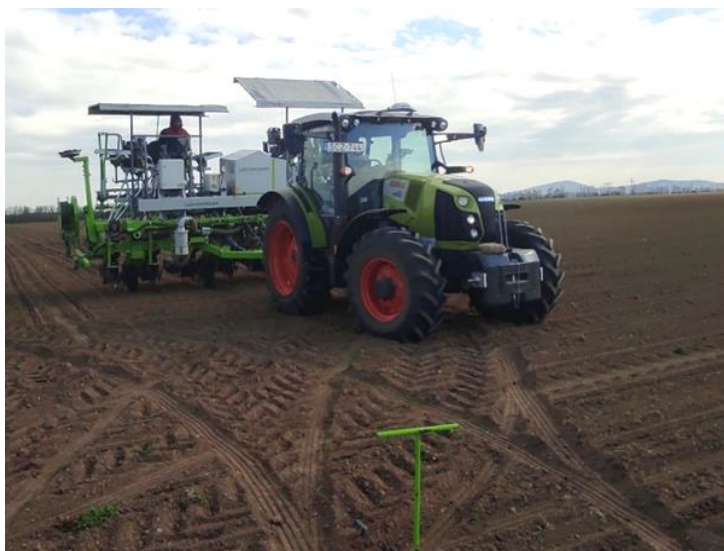
5. ábra: Claas Arion 420 Trimble TMX 2050 sorvezető rendszerrel ellátva végezte a vetést
