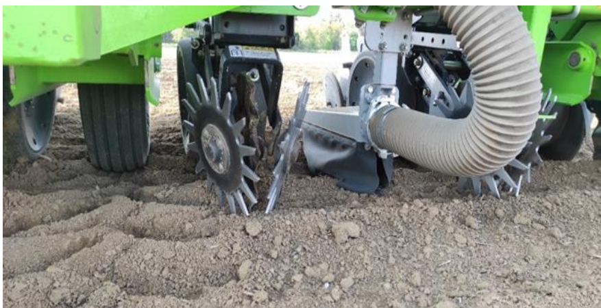
7. ábra: Wintersteiger Dynamic Disc vetőgép 6 cm mélységben vetette el a szemet
