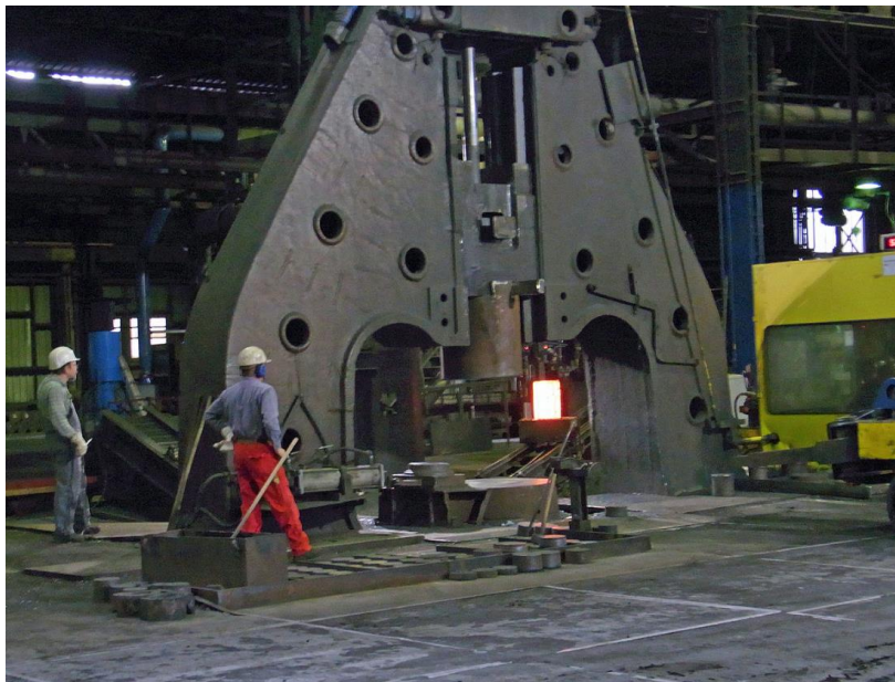
9. ábra: Szabadalakító, gravitációs elven működő kalapács-berendezés
