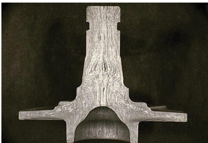
7. ábra: Egy kovácsolt tengelycsenk belső szerkezete [21]
