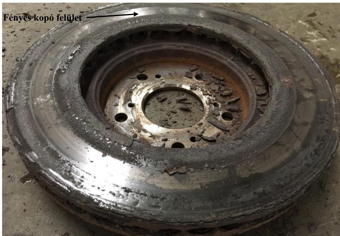
18. ábra: Az elhasznált, kitöredezett kopófelületű féktárcsa egy személyautóból
