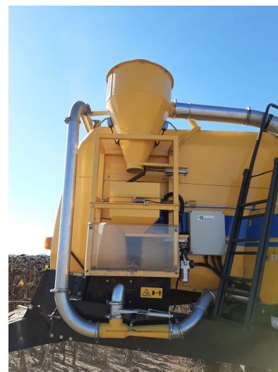
10. ábra: Parcella-kombájnnra szerelt mérleg és mintavevő rendszer.
