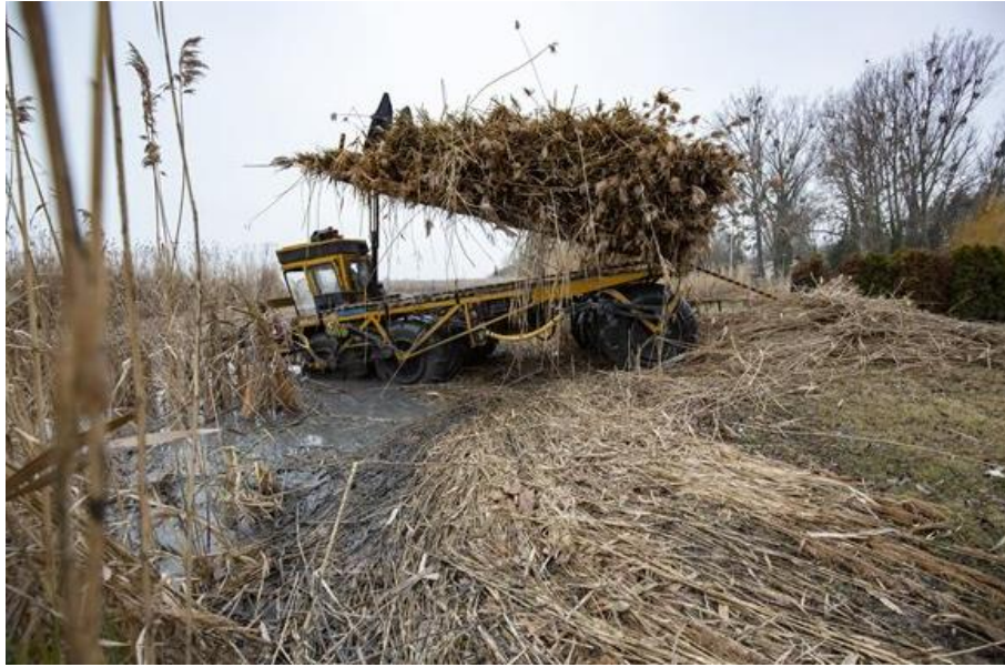
5. ábra A speciális nádarató kombájn platója dönthető, így a gép megkönnyíti a kévék rakodási munkafolyamatait. Balatongyörök. 2020. januári fotó: MTI / Varga György (Ábra forrása: INTERNET 15)
