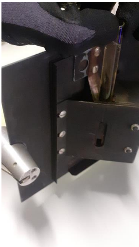
20. ábra A mintatartó küvette helye a fluorométerben (Saját kép)
