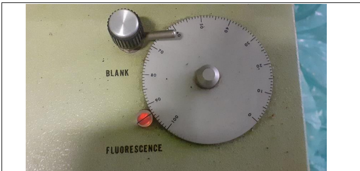
18. ábra: Fluoreszcencia mérés, eredmény a mintán levő festékanyag mennyiségéhez tartozó műszerszám: 93 (Saját kép)
