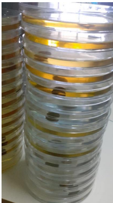
16. ábra: Petricsészék, melyekben 2 db 6,28 \text{ cm}^2 felületű levélminta található (Saját kép)
