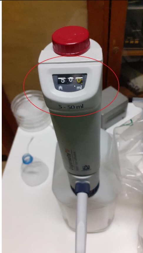
15. ábra: Automata pipettával 50 ml desztillált vizet adagoltunk minden Petri csészébe (Saját kép)
