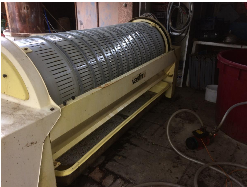
7. ábra 2017 Szőlő préselés Vaslin Veritas 10 géppel
