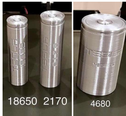
12.Kép: A Tesla által használt akkumulátorok, 18650, 2170, 4680
