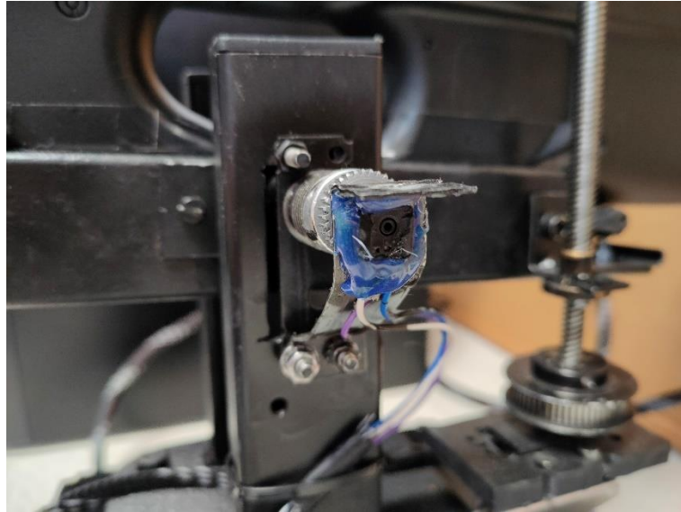
22. ábra - A potméter rögzítési megoldása (saját kép)
