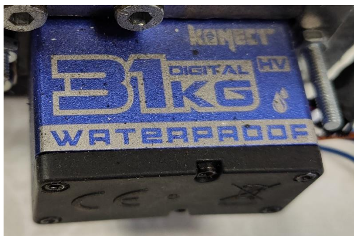
15. ábra - KONECT 31 kg CORELESS HiVOLT WATERPROOF Digital servo (saját kép)
