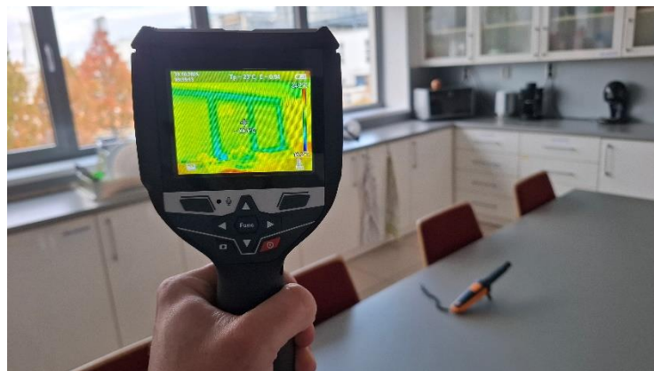
16. ábra Bosch GTC 600c hőkamera (forrás: saját ábra)
