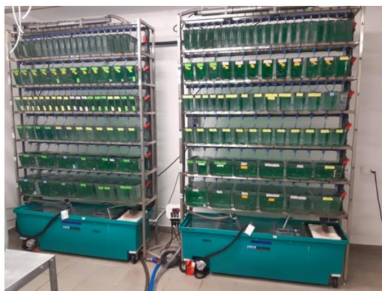
6. ábra: Az Aquaneering recirkulációs haltartó rendszer. A rendszerben a víz folyamatosan keringve tisztul meg több lépésben. A rendszer alján mechanikai és biológiai szűrésen, a rendszer tetején pedig UV fertőtlenítésen megy át a keringetett víz. A rendszeren láthatóak a különböző térfogatú tartályok, amelyekben a különböző méretű halak csoportjait tartjuk (Fotó: Marton Csaba).
